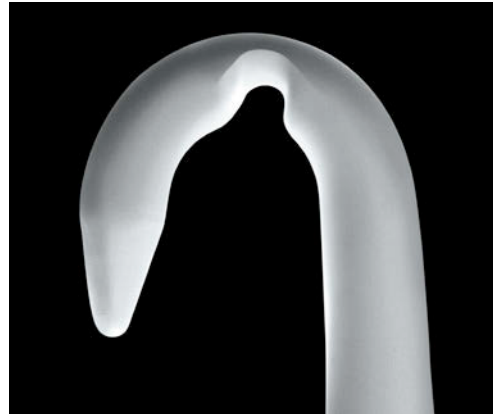
Verschleiß im Hakeninnenbogen (ohne Beschichtung)
